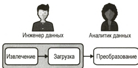
Рис. 3.3. Шаблон ELT позволяет четко разделить обязанности между инженерами данных и аналитиками (или учеными). Каждый специалист может работать автономно с удобными для него инструментами и языками
