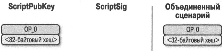
Рис. 13.22. Поля ScriptPubKey и ScriptSig для оплаты по хешу сценария с раздельным заверением (p2wpkh)
