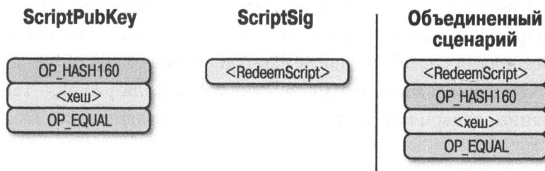
Рис. 13.11. Поле ScriptPubKey в p2sh-p2wpkh оказывается таким же, как и обычное поле ScriptPubKey в p2sh
