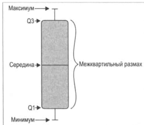
Рис. 1.18. Элементы блочной диаграммы
