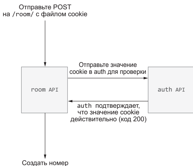
Рис. 4.3. Пример визуализации для дизайна API, чтобы облегчить обсуждение
