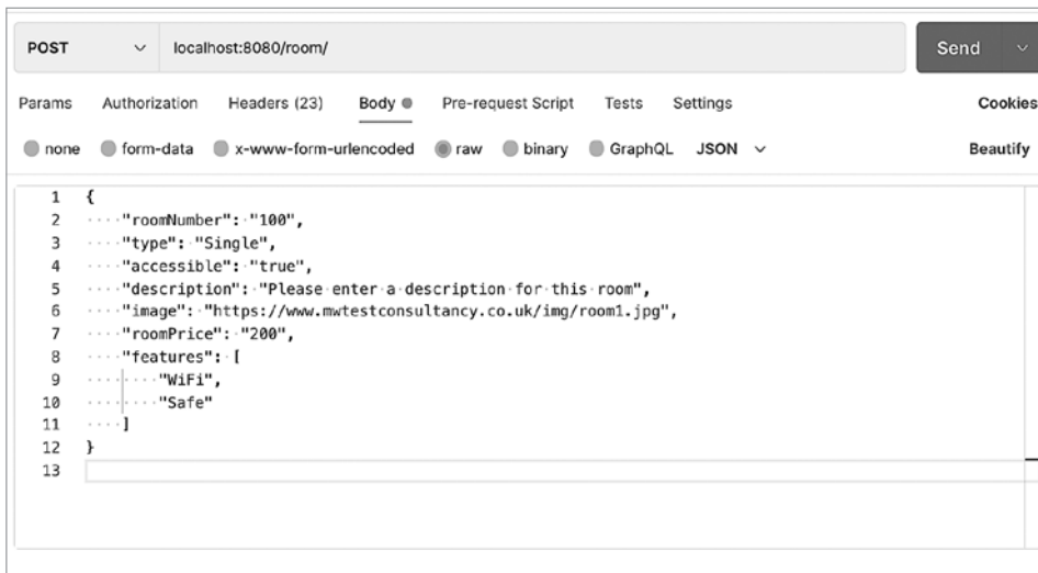
Рис. 2.3. HTTP-запрос POST для API с использованием Postman, который позволяет создать комнату
