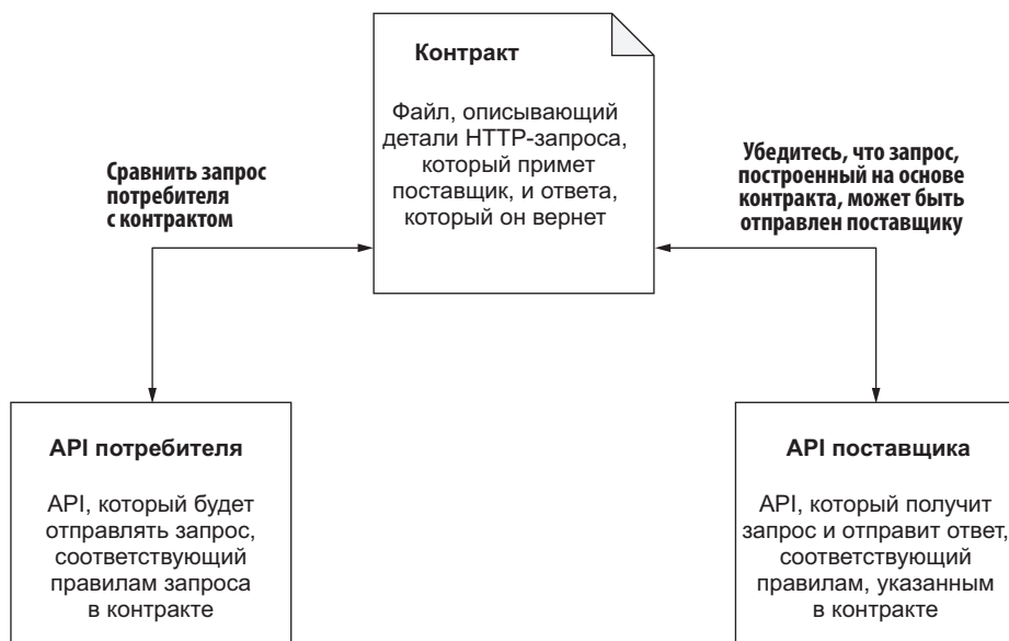
Рис. 9.1. Модель, описывающая взаимосвязи и порядок проведения контрактного тестирования
