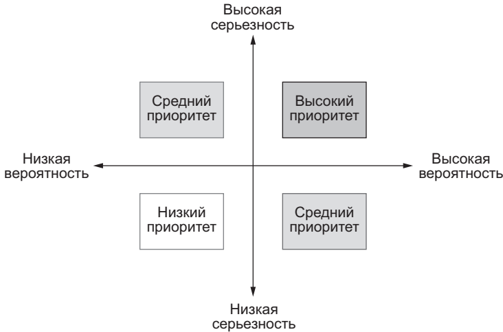
Рис. 3.4. Модель приоритизации рисков на основе их вероятности и серьезности
