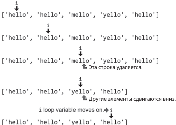
Рис. 8.2. Когда цикл удаляет 'mello', элементы списка сдвигаются на одну позицию вниз, в результате чего i пропускает элемент 'yello'
