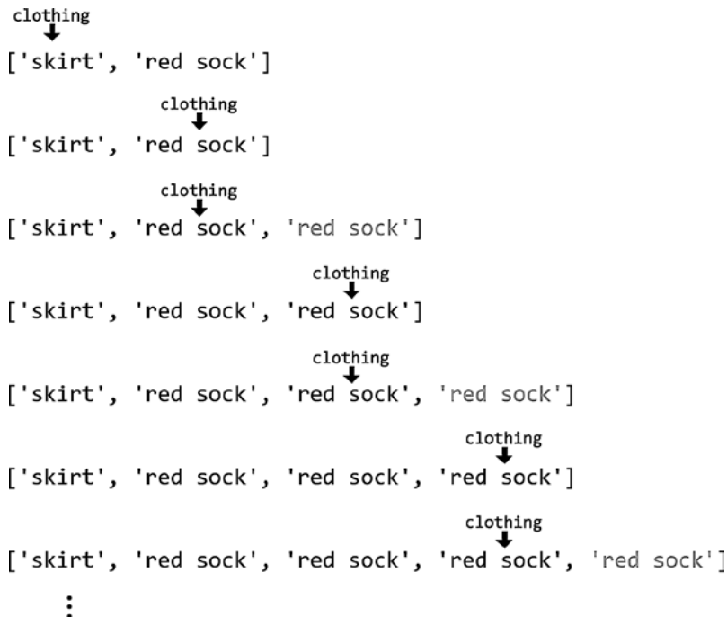
Рис. 8.1. При каждой итерации цикла for к списку присоединяется новый объект 'red sock' , к которому clothing переходит при следующей итерации. Цикл повторяется бесконечно
