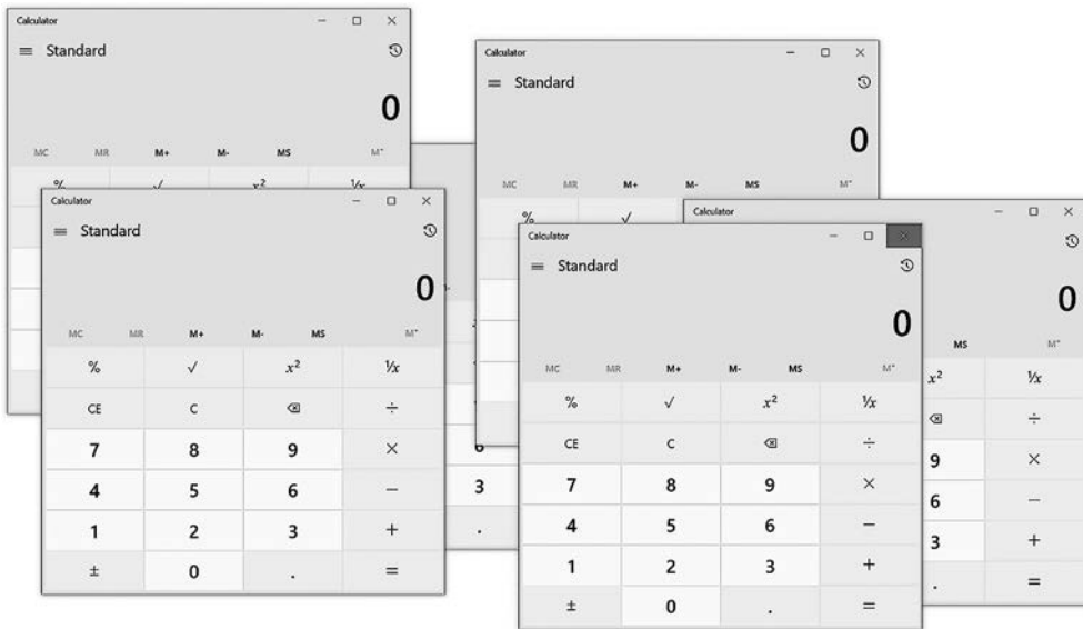
Рис. 2.3. Одна программа-калькулятор запущена в нескольких экземплярах, каждый экземпляр является отдельным процессом
