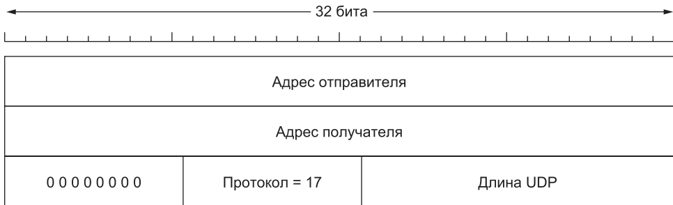
Рис. 6.24. Псевдозаголовок, включаемый в контрольную сумму UDP
