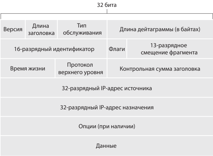
Рис. 4.13. Формат дейтаграммы IPv4
