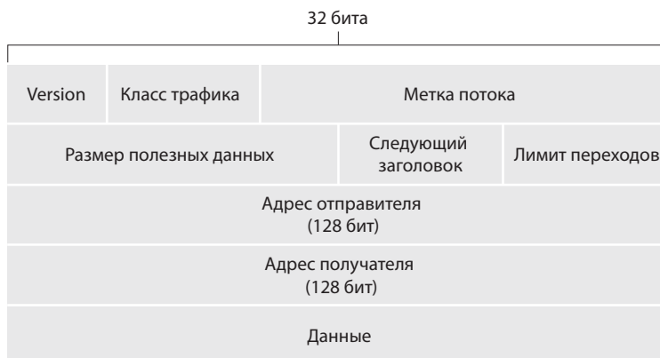
Рис. 4.24. Формат дейтаграммы IPv6
