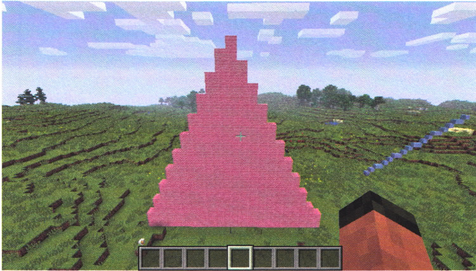
Рис. 6.8. Использование drawFace() для создания треугольной формы из трех точек
