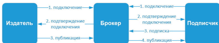
Рис. 9.1. Схема простого взаимодействия по протоколу MQTT
