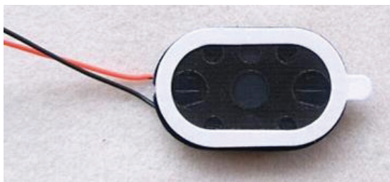
Рис. 5.4. Динамик для звуковой сигнализации
