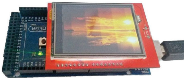
Рис. 5.10. Установка TFT Shield 2.4" 240×320 на плату Arduino MEGA
