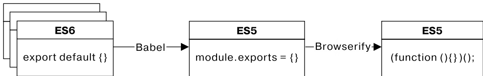
Рис. 17.10. Преобразование из модулей ES6 в модули ES5 с помощью Babel и Browserify
