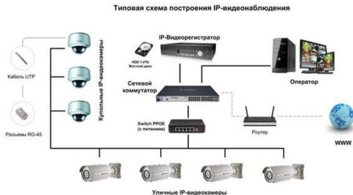
Диаграмма: Типовая схема цифровой системы видеонаблюдения
