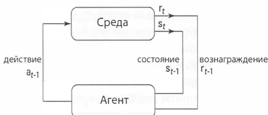
Рис. 17.1. Схема связи агента и среды в RL
