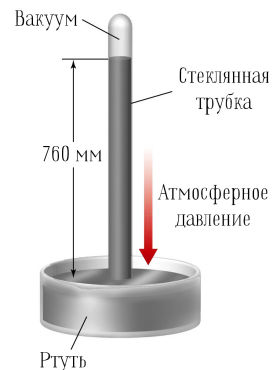
РИС. 8 Схема простейшего ртутного барометра
