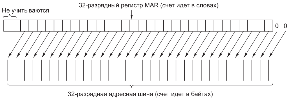
Рис. 4.3. Распределение битов регистра MAR в адресной шине
