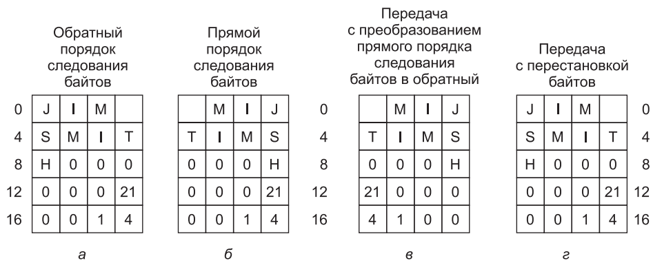
Рис. 2.10. Запись данных о сотруднике для машины с прямым порядком следования байтов (а); та же запись для машины с обратным порядком следования байтов (б); результат передачи записи с машины с прямым порядком следования байтов на машину с обратным порядком следования байтов (в); результат перестановки байтов в предыдущем случае (г)
