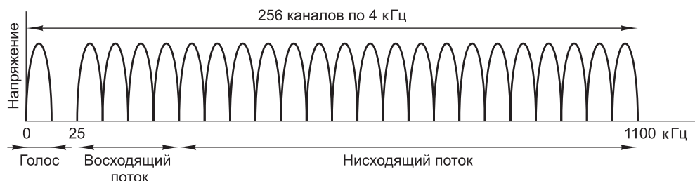
Рис. 2.35. Функционирование ADSL
