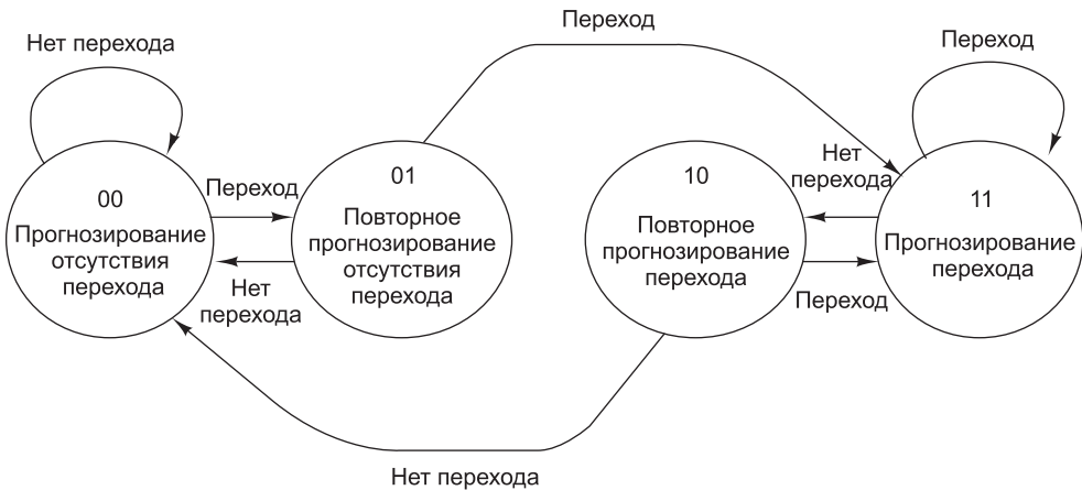
Рис. 4.29. 2-разрядный конечный автомат для прогнозирования переходов
