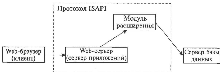
Рис. 13.1. Схема реализации процедуры Web-публикации
