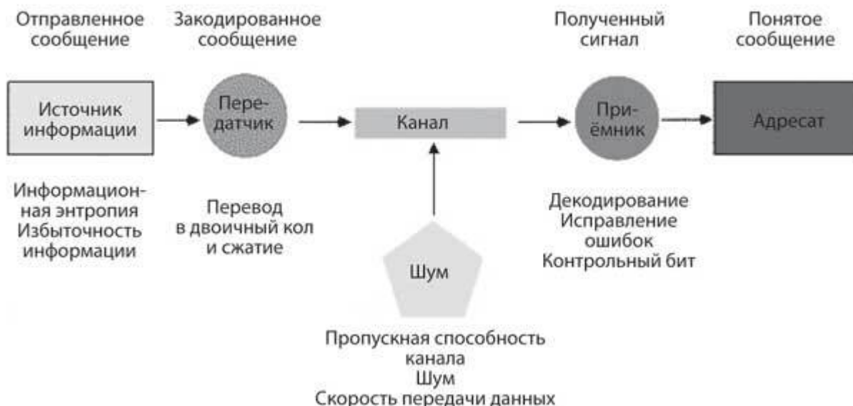
Рис. 15.2. Модель коммуникационной системы Шеннона. Сообщение переводится в двоичный код и передается по каналу, которым может быть телефонная линия или радиоволна, туда, где оно принимается и декодируется. Пропускная способность канала зависит от уровня шума в системе
