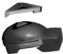
Рис. 3.47. Ультразвуковая СВО Logitech Head Tracker
