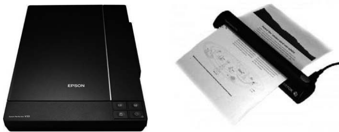
Рис. 3.7. Планшетный (слева) и роликовый сканеры
