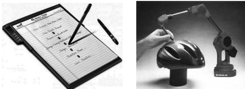
Рис. 3.3. Плоский (слева) и 3D-дигитайзеры
