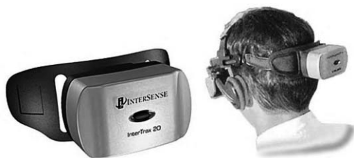
Рис. 3.48. Датчик инерциальной СВО INTERTRAX
