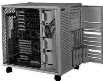
Рис. 1.13. Конструкция корпуса с системной платой форм-фактора WTX
