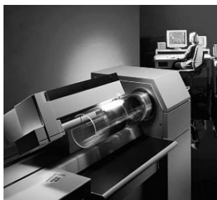
Рис. 3.10. Барабанный (слева) и проекционный сканеры
