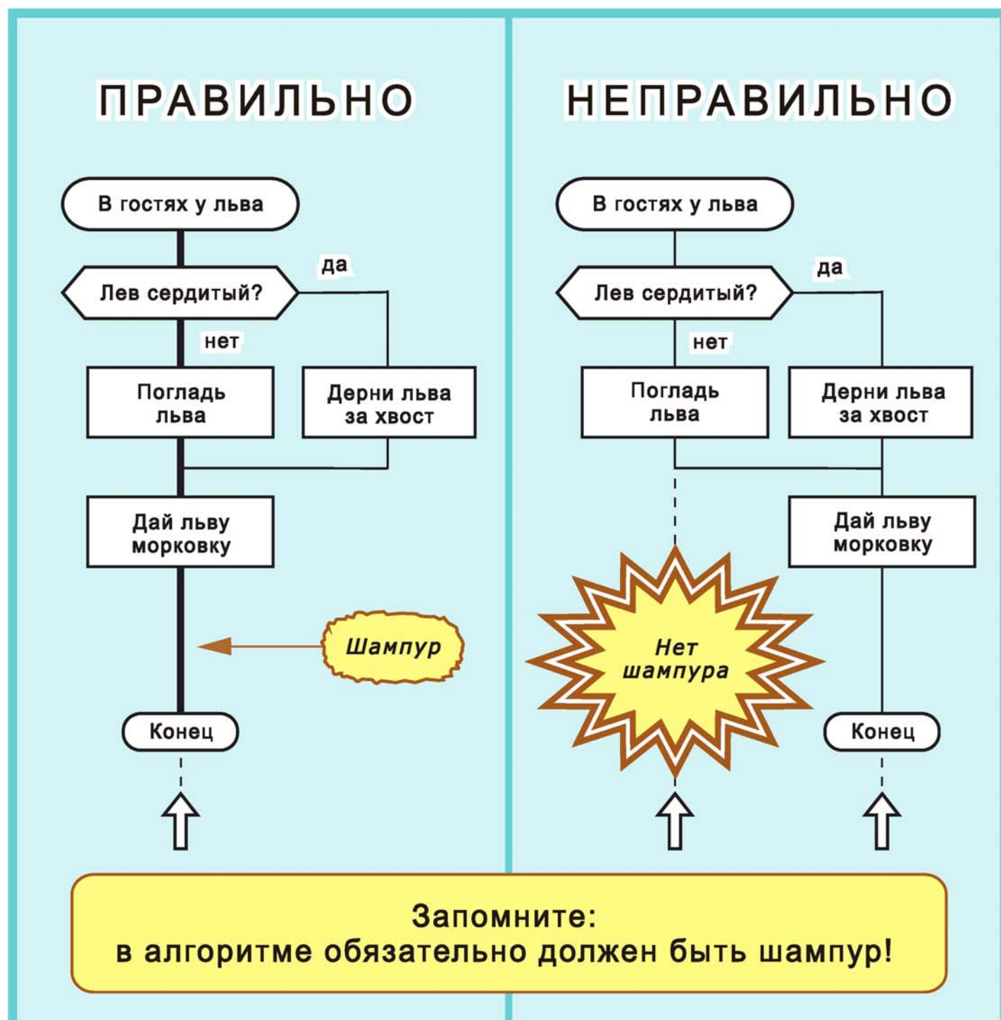
Рис. 27. Правильно нарисованный алгоритм. Иконы «заголовок» и «конец» лежат на одной вертикали. Эта вертикаль называется «шампур» (жирная линия).
