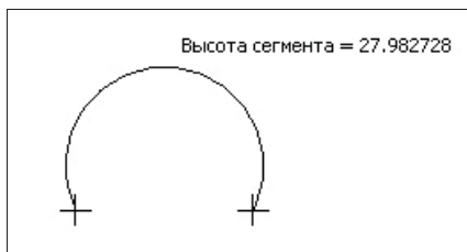
Рис. 6.10. Построение дуги по трем точкам
