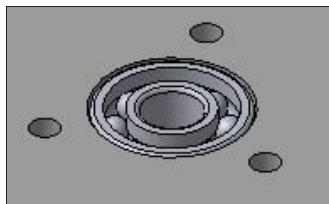
Рис. 30.27. Правильно установленный подшипник в плате
