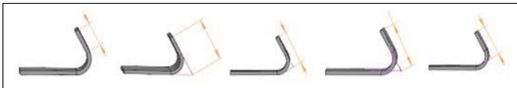
Рис. 29.15. Варианты построения сгиба в зависимости от способа задания длины
